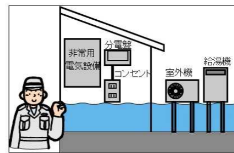
図 7-10 電気設備の浸水対策
