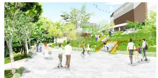
透水性舗装やバイオスウェルを採用し、雨水浸透機能を確認するとともに、レインガーデンを取り入れたランドスケープデザイン（南町田グランベリーパーク、町田市）
