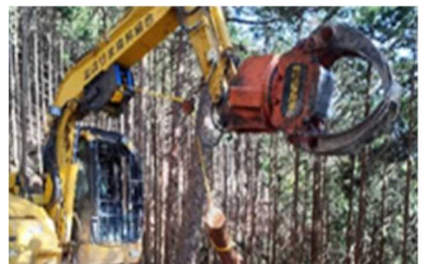
既存林業機械の改良（横引き滑車の取付）による 作業の効率化と安全性の向上（多可町）
