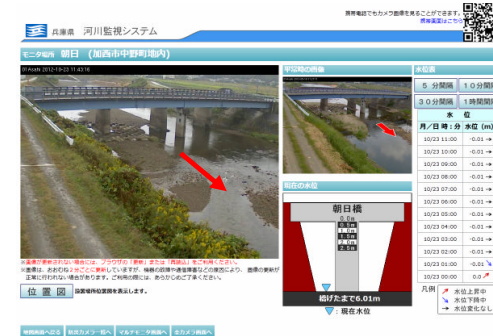
兵庫県 河川監視システム
