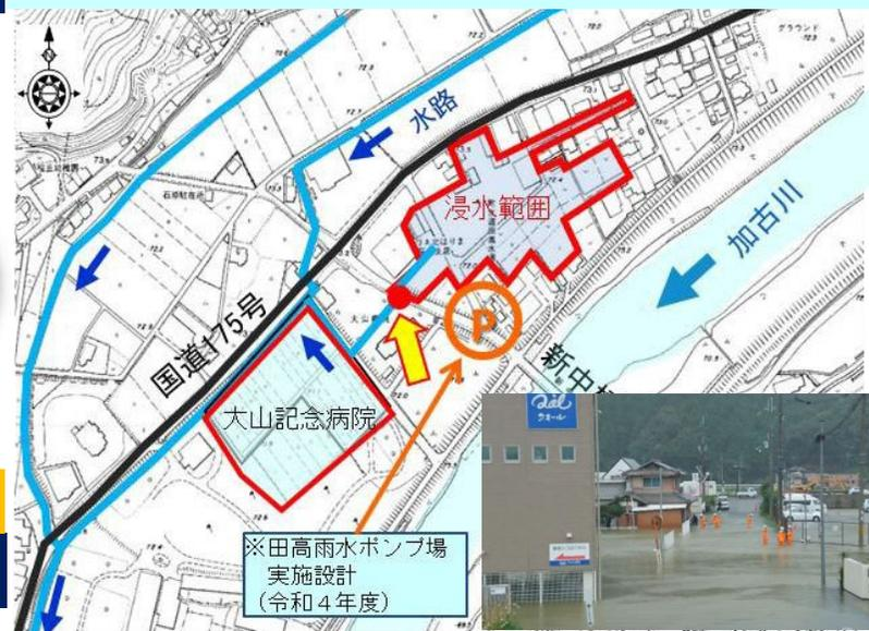
加古川の水位上昇により水路から逆流し、浸水被害が発生
