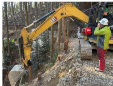
繊維ロープと電動ウインチを使用した集材の検証（多可町）
