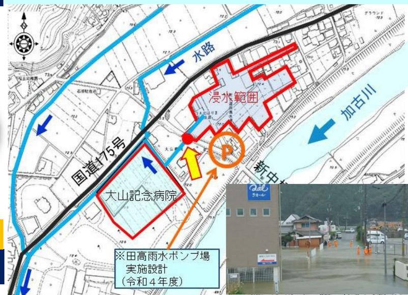
加古川の水位上昇により水路から逆流し、浸水被害が発生
