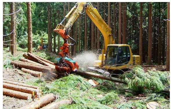
高性能林業機械による造材作業 (宍粟市一宮町)
