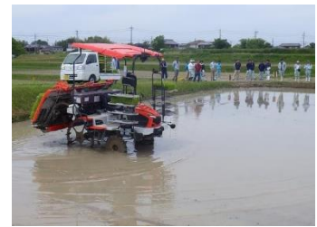
非熟練者1人でも高速・高精度な田植えが可能な自動運転田植機
