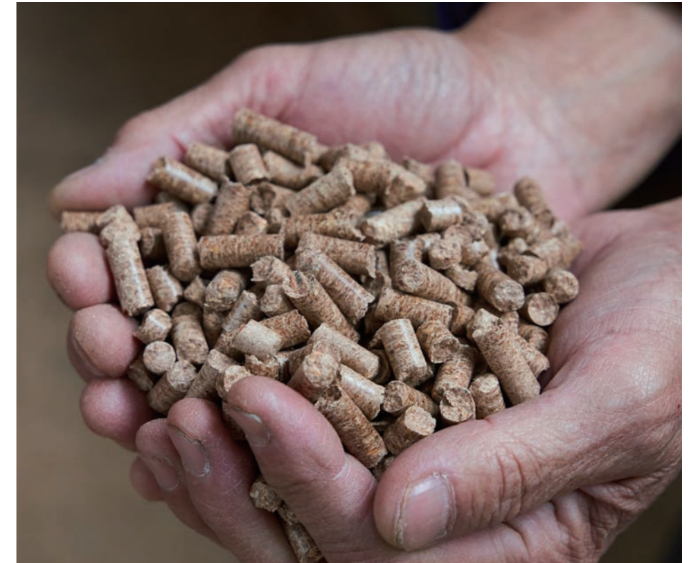
製材時の廃材や間伐材を圧縮成型した固形燃料「木質ペレット」
