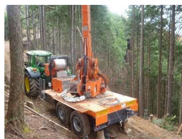
架線集材に対応した高性能林業機械(タワーヤーダ)
