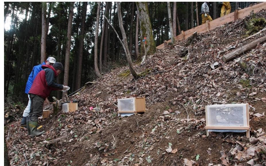
写真 土砂受け箱の設置状況
