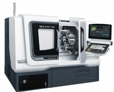
【無償貸与されるターニングセンタ】 コンピュータ制御により、極めて精緻な金属部品の加工が可能
