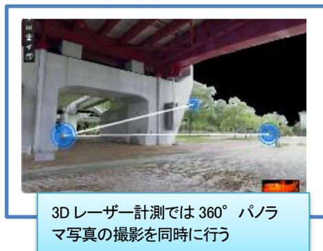
3Dレーザー計測では360°パノラマ写真の撮影を同時に行う
