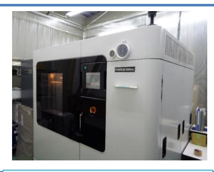
3Dプリンター装置 914mm×614mm×914mmまで 製作が可能な超大型高速造形機
