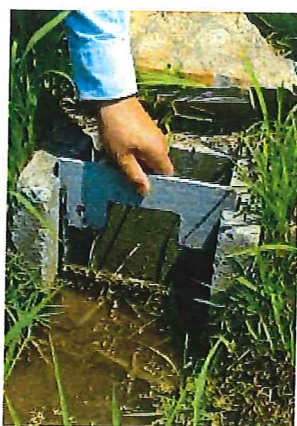
せき板による水位調整
