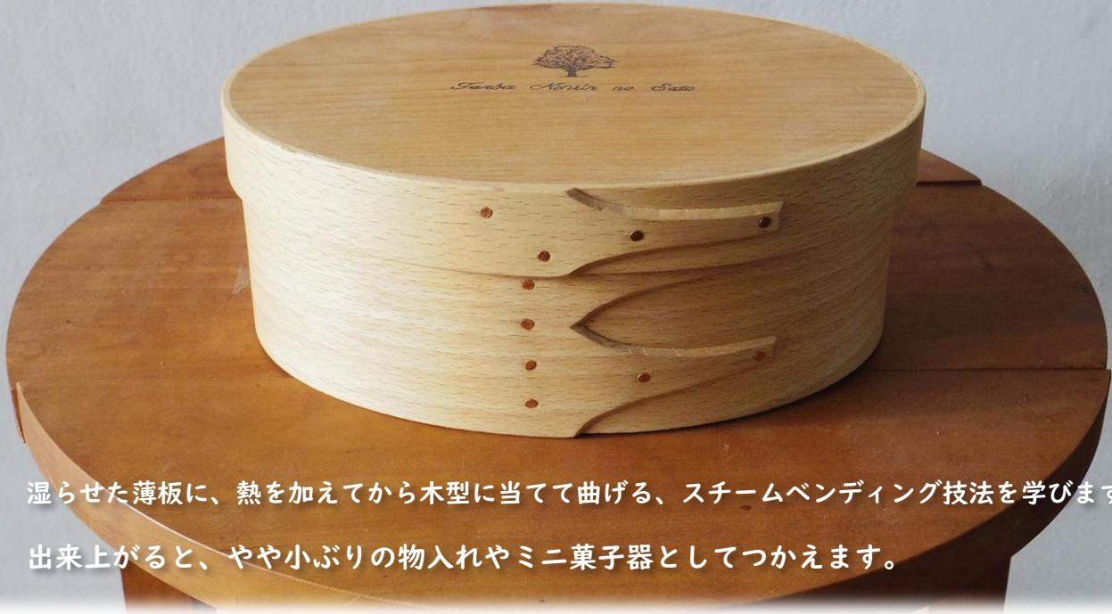
湿らせた薄板に、熱を加えてから木型に当てて曲げる、スチームベンディング技法を学びます。
